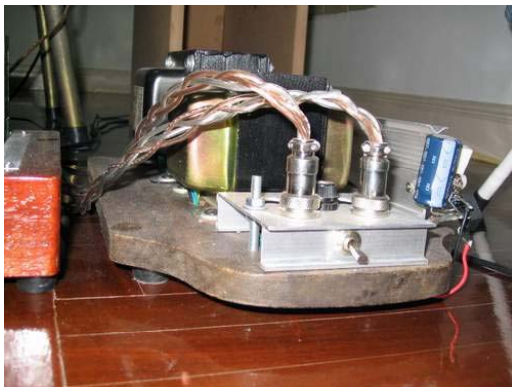
รูปหม้อแปลงและภาคจ่ายไฟ
