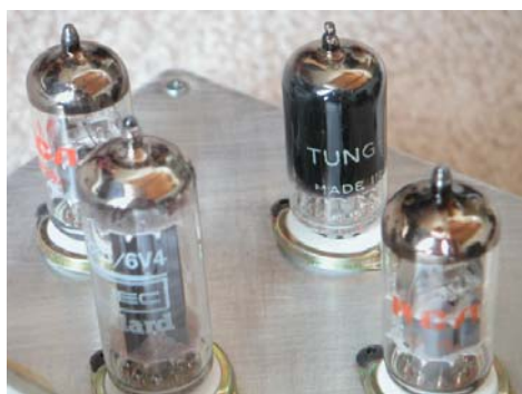
หลอดที่ใช้กับ Head Amp OTL ตัวนี้
