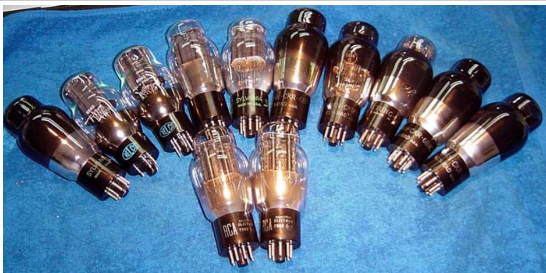
หลอด Dual Plate 6B4G โครงสร้างภายในก็ดูเหมือนๆ กับ 2A3
