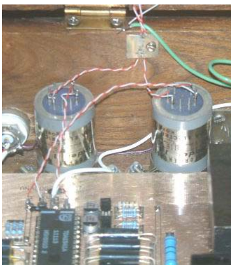
ติดตั้งไวโกลักับ TDA1541A ให้มากที่สุด
