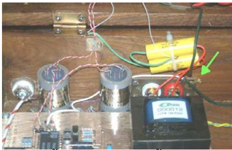
ลูกศรชี้จุดที่รวม Ground ทั้ง 3 ชุด ทรง กระบอกสี่เหลี่ยมข้างๆ ก็คือ C Hovland
