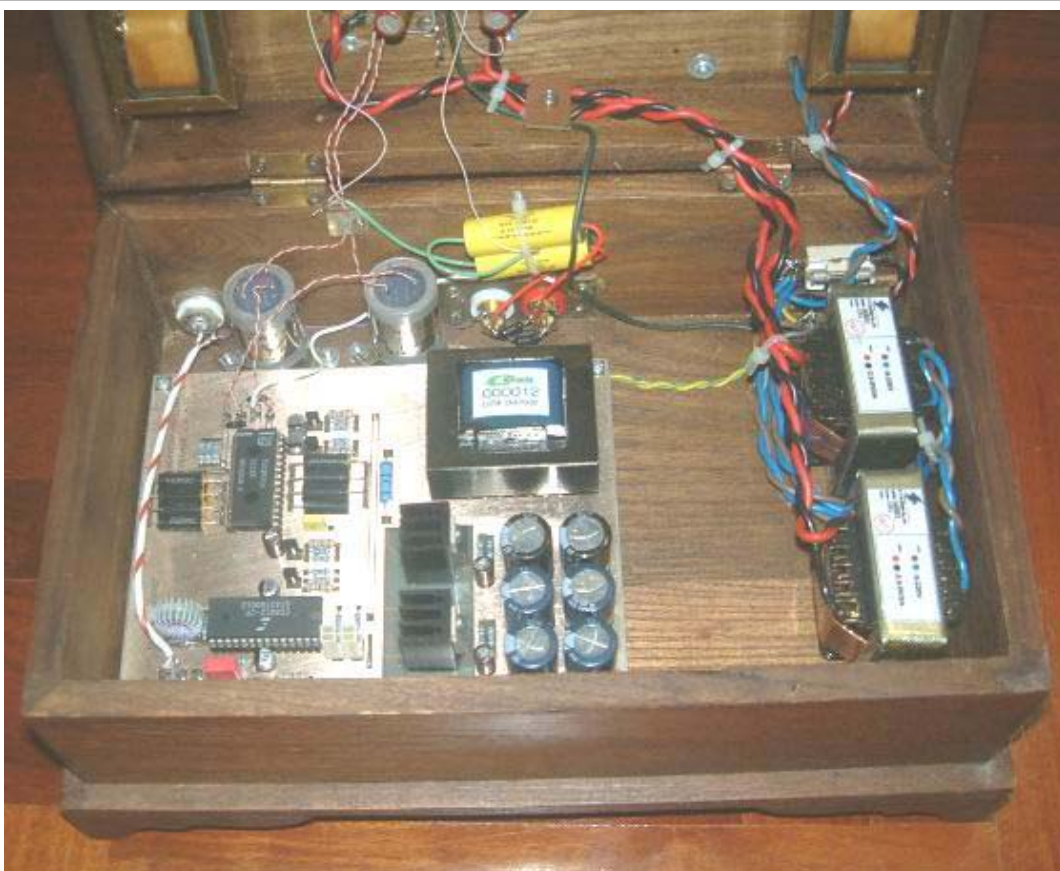
ติดตั้ง Digital Board และหม้อแปลงไส้หลอดไว้ในหีบแล้ว ยังพอเหลือที่หายใจนิดหน่อย
