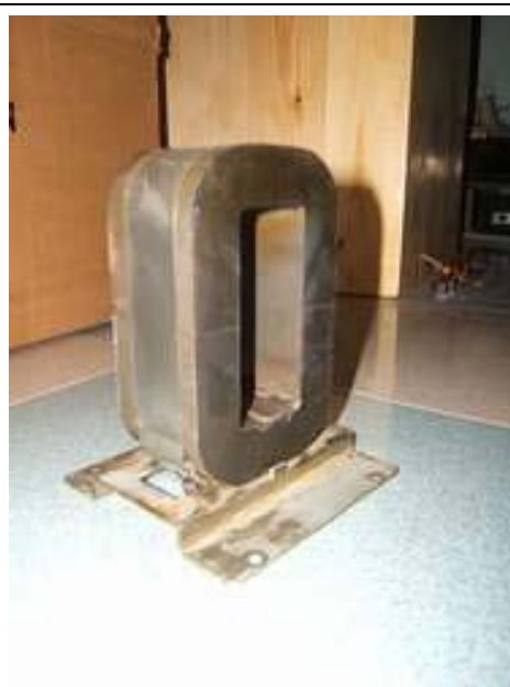
C-Core ที่ได้นี้ ทำให้ OPT ในบทความนี้ไม่เป็น Last
