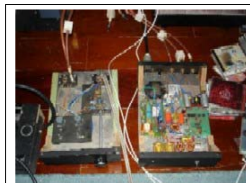
ด้านซ้ายมือปริ Passive ใช้หม้อแปลง Coupling ด้านขวา DAC
