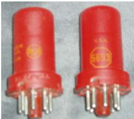
หลอด 5693 ของ RCA (Special 6SJ7)
