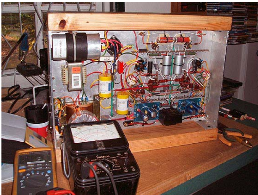
การเดินสายภายในเครื่องและการตรวจวัดขั้นสุดท้าย
