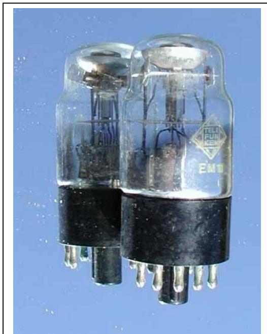
Telefunken EM11 Indicator Tube ใช้กันมาก ในวิทยุโบราณที่ผลิตจากเยอรมัน
