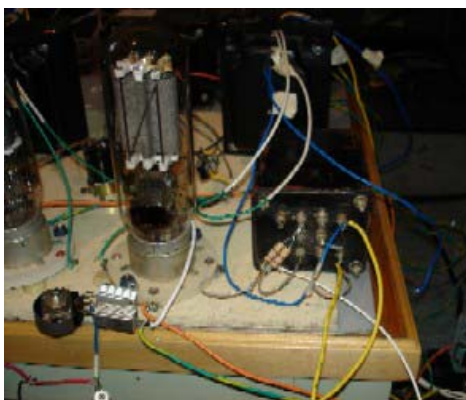
ชุด Driver 6SN7 ขั้ว 2E22 และอุปกรณ์ภาคหน้าทั้งหมด
