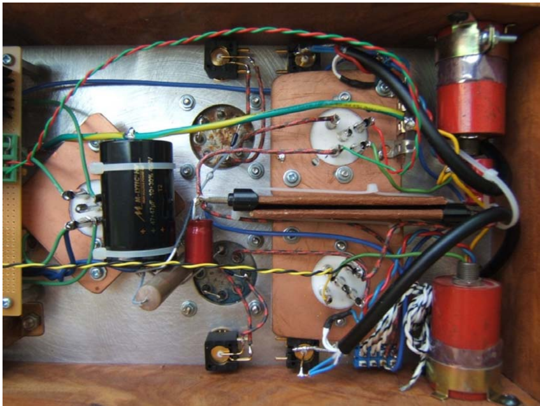
ส่วนของภาคขยายครีบก้อนแดงๆ ด้านขวานั้นคือ Input Transformer 600:600
