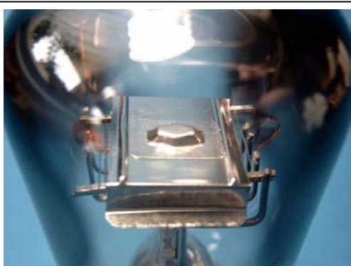
ลักษณะ Plate แนวนอนของหลอด RE084k
