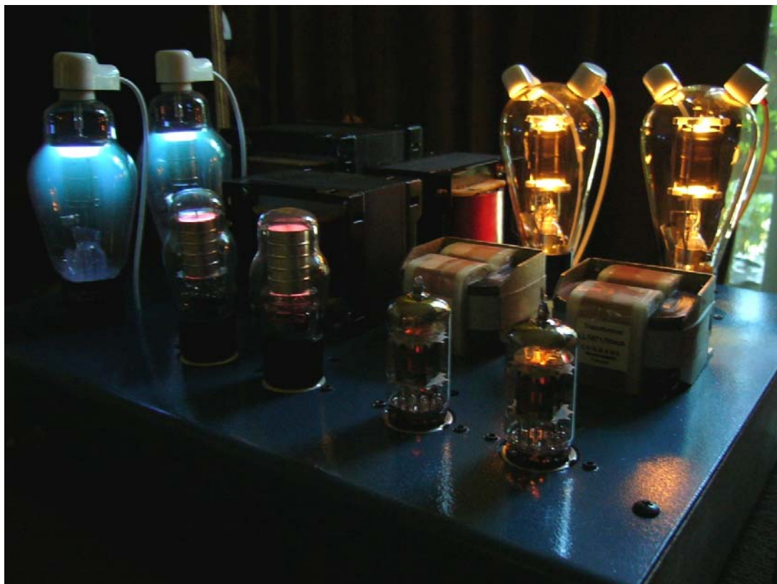
VT-64 ภาคสอง Drive ด้วยหลอด E55L
