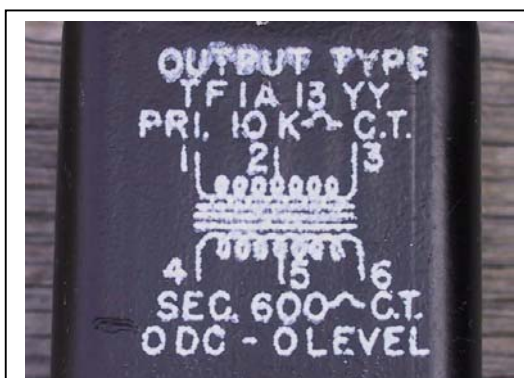
ตัวอย่าง Transformer ที่ไม่สามารถรองรับกระแสไฟ DC ผ่านขด Primary ได้
