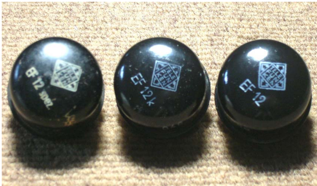
Telefunken EF12 Spez., EF12k, EF12
