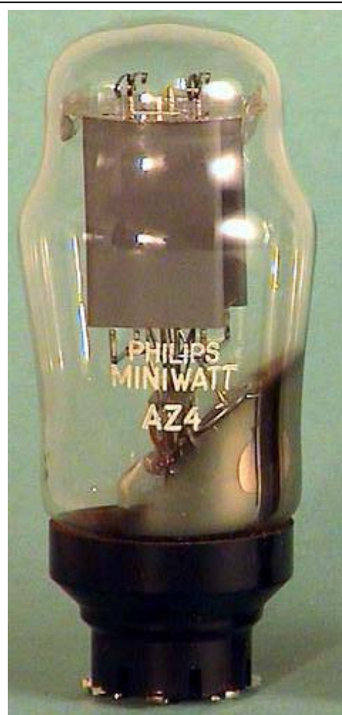
AZ4 ใช้ Socket German Side-Contact ซึ่งจะหายากซักหน่อยในบ้านเรา
