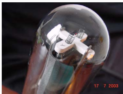
Graphite Plate อย่างเช่นหลอด 211 มักจะให้เสียงอบอุ่นต่างจากเพลทชนิดอื่น
