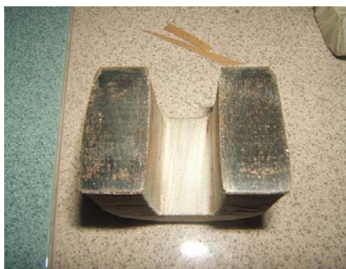
แกนของเรา Amorphous C-Core
