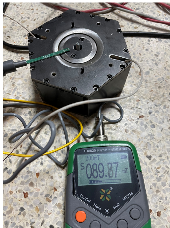
ค่าสนามแม่เหล็กใน Air-Gap 2,008mT เทียบ กับที่วัดออกมาจากผิวบน 89.8mT
