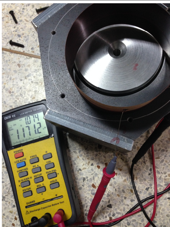
ค่า Inductance Voice Coil ใน Free-air
