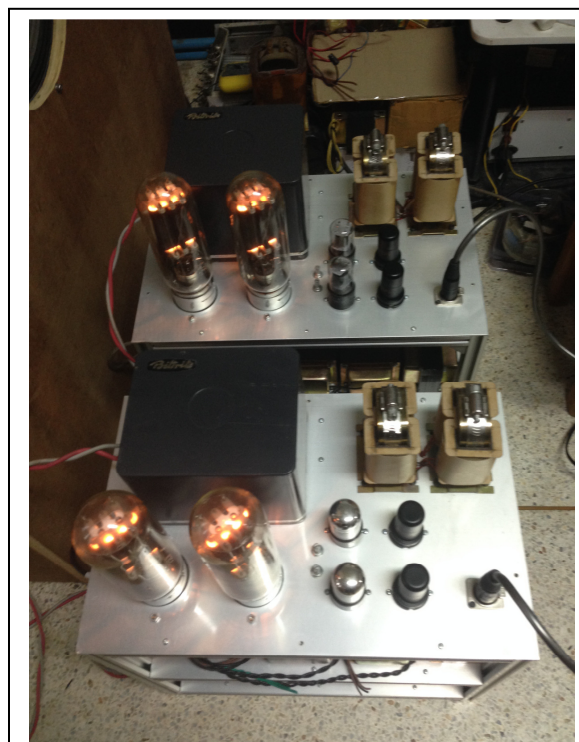
ทำเป็น Mono-Block Block ละ 3 ชั้น
