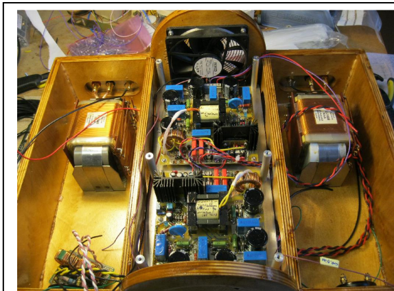
ภาคจ่ายไฟ SMPS อยู่ตรงกลาง
