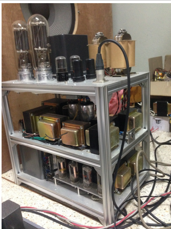
ชั้นบนเป็นวงจรขยายทั้งหมด ส่วน 2 ชั้นล่างเป็นภาคจ่ายไฟ
