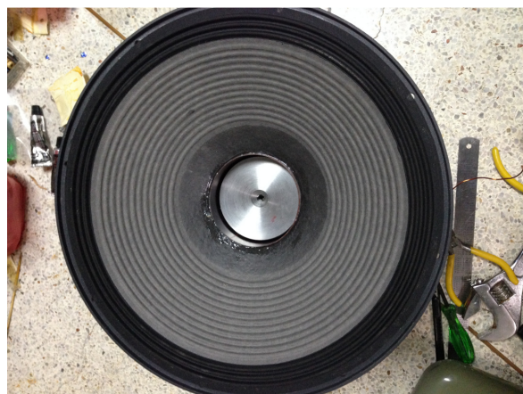
ทดสอบฟังก์ชันปิด Dust Cap เป็นขั้นตอนสุดท้าย
