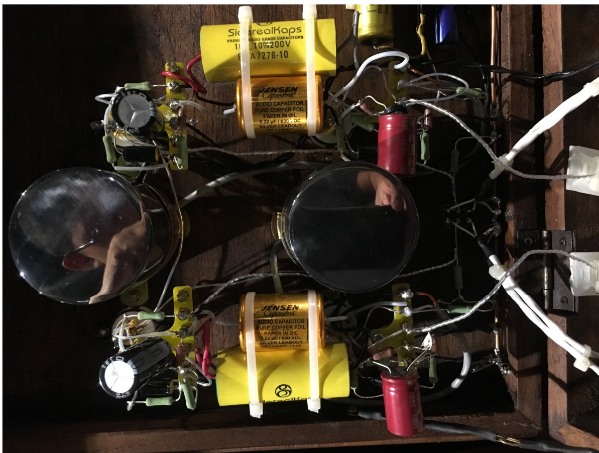
ก้อนกลมสีเงินคือ Silk LCR Network, C Coupling เป็น SiderealKaps 10uF and Jensen Copper Foil
