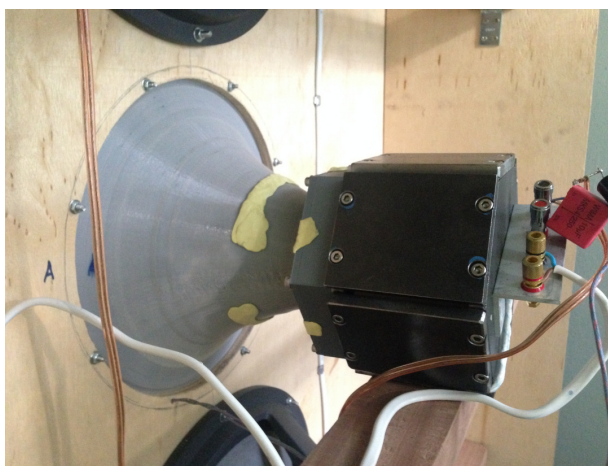
ประกอบ Driver กับ Horn หลัง Driver เป็นขั้วต่อไฟ
