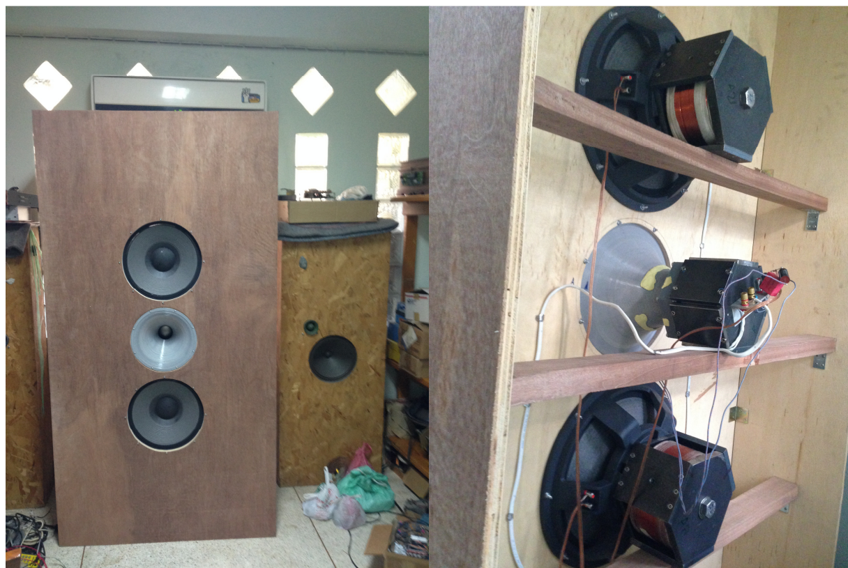
ซ้าย : Upsize จาก Baffle อันเดิมที่ใช้มา 10 กว่าปี ขวา : Driver แต่ละตัวต้องเอาคานมาหาม
