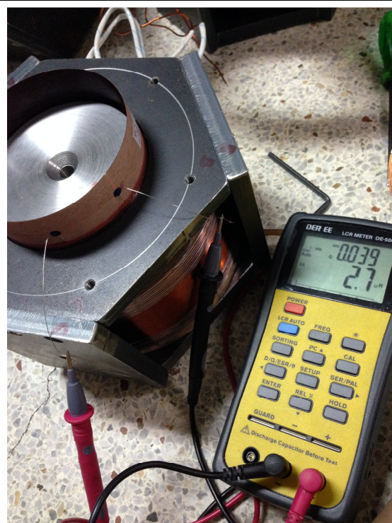
ค่า Inductance Voice Coil ใน Magnet Gap
